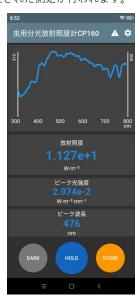
測定中は、分光分布、測定値がリアルタイムに更新されます。測定を保持するときは、 HOLDボタンをタップしてください。MEAS ボタンをタップすると測定を再開します。
